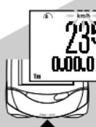
START/STOP ボタンを一回押すと計測を開始し、もう一回押すと停止します。計測中は速度単位が点滅します。
