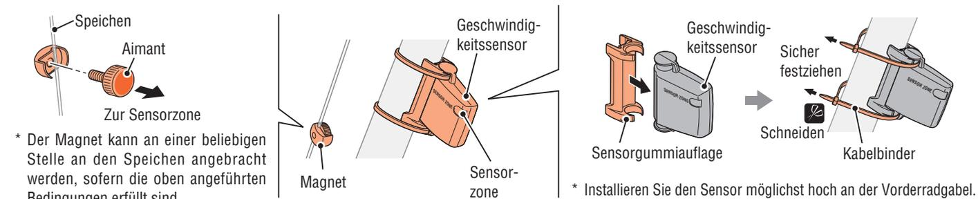
\* Der Magnet kann an einer beliebigen Stelle an den Speichen angebracht werden, sofern die oben angeführten Bedingungen erfüllt sind.
