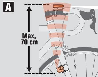
Der Abstand zwischen Computer und Sensor liegt innerhalb der Datenübertragungreichweite; die Rückseite des Computers zeigt nach unten.
