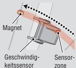
**C** Der Abstand zwischen Sensor und Magnet beträgt maximal 5 mm.
