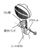
取付バンドをゴム板と共にシートポストに巻付けます。取付バンドのサイズが合わない場合、ゴム板を適当な長さに調節してください。
