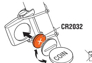
\* Dopo la sostituzione, verificare le posizioni del sensore e del magnete.
