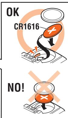
\* Dopo la sostituzione, seguire la procedura indicata nella sezione "Preparazione del computer" (Impostazione).
