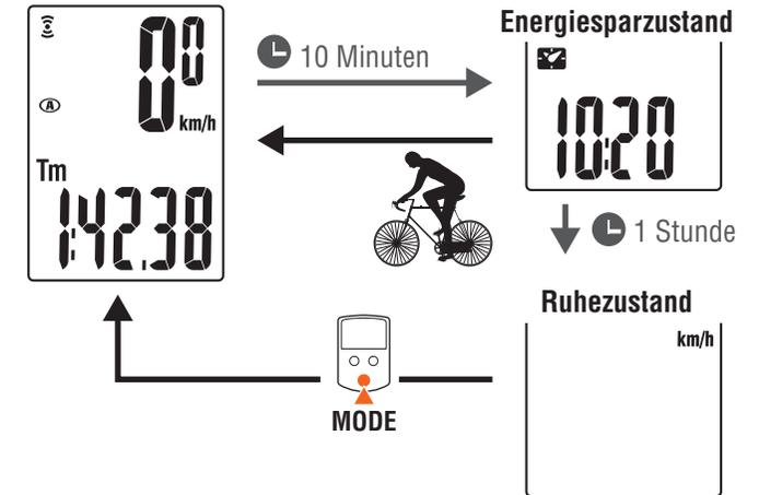
Wenn nach Aufrufen des Energiesparmodus weitere 60 Minuten keine Aktion erfolgt, wird nur die Geschwindigkeitseinheit im Bildschirm angezeigt. Bei Anzeige dieses Bildschirms kehren Sie durch Betätigung der **MODE**-Taste zum Messbildschirm zurück.
