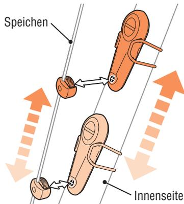
Wählen Sie in etwa eine Montageposition, bei welcher der Abstand zwischen Magnetoberfläche und Sensorzone maximal 5 mm beträgt, indem Sie Sensor und Magnet vor der Montage nach oben und unten schieben.
