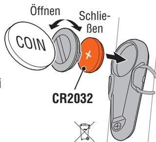
\* Prüfen Sie nach dem Ersetzen die Positionen von Sensor und Magnet.
