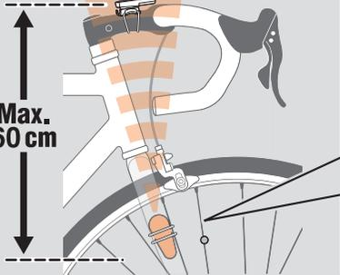
**B** Der Magnet muss die Sensorzone durchlaufen.
