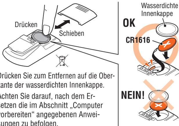
\* Drücken Sie zum Entfernen auf die Oberkante der wasserdichten Innenkappe.
