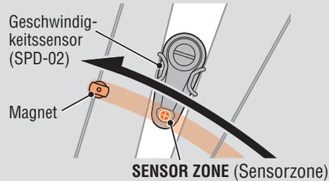
**C** Der Abstand zwischen Sensor und Magnet beträgt maximal 5 mm.
