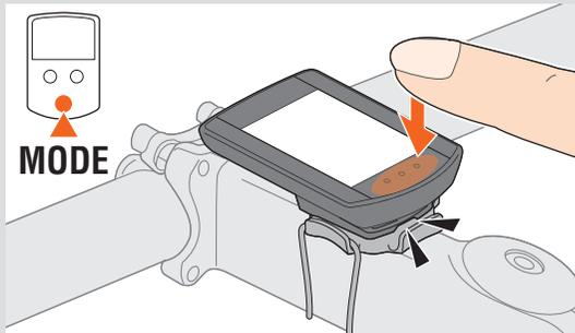
Wenn der Computer an der Halterung montiert ist, wird bei Betätigung des Punktbereichs am Gerät die **MODE**-Taste gedrückt.
