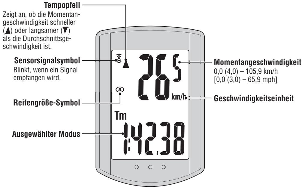
**MODE-Betrieb, wenn der Computer an der Halterung befestigt ist**
