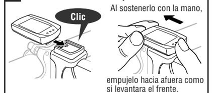
\* Después de la instalación, gire la rueda delantera suavemente para comprobar que se visualiza la velocidad en la computadora. Si no se visualiza, compruebe que las condiciones A) y B) se cumplan.
