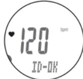
\* L'appareil entre en mode recherche pendant 5 minutes après le démarrage de la synchronisation du numéro d'identification. Appuyez sur la touche **SSS** en mode de recherche pour annuler la synchronisation du numéro d'identification et «**ID-SKIP**» s'affiche. Si aucun signal n'est reçu en provenance du capteur en 5 minutes, «**ID-ERROR**» s'affiche. Si «**ID-SKIP**» ou «**ID-ERROR**» s'affiche, le numéro d'identification n'a pas été correctement synchronisé.
