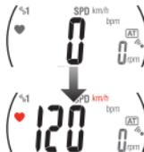
\* Vous pouvez aussi activer le capteur de fréquence en frottant avec vos pouces les deux tampons d'électrodes. Vous ne pouvez pas utiliser cette méthode pour mesurer précisément le rythme cardiaque, mais vous pouvez l'utiliser comme méthode simple pour tester la communication capteur/montre et rechercher le numéro d'identification du capteur.
