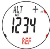
4. Sélectionnez «+» ou «-» dans l'altitude du niveau moyen de la mer Changez ensuite chaque chiffre de la valeur un par un à l'aide des touches **MODE1** et **MODE2**, puis faites défiler les chiffres à l'aide de la touche **SSS**.
