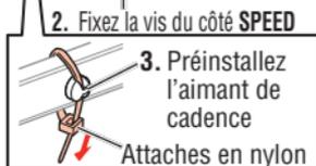
\* Si le capteur de vitesse n'est pas positionné correctement par rapport aux deux aimants (aux étapes 2 et 3), déplacez-le d'avant en arrière jusqu'à ce qu'il soit en bonne position. Après avoir déplacé le capteur de vitesse, ajustez la position de façon à ce que les deux aimants se trouvent chacun face à la zone surveillée par le capteur correspondante.
