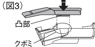
丸でしるした所を押しながら上ボディをレンズ側にずらし(図1)、本体の刻印に従って電池を入れます(図2)。上ボディの凸部を下ボディのクボミにはめ、はずす時とは逆の手順で元に戻します(図3)。
