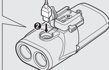
1. Branchez le bloc d'éclairage sur votre PC ou sur un chargeur de batterie USB du commerce en utilisant le câble USB. (Fig 1 ① – ②). Le bouton s'allume et le chargement commence.
