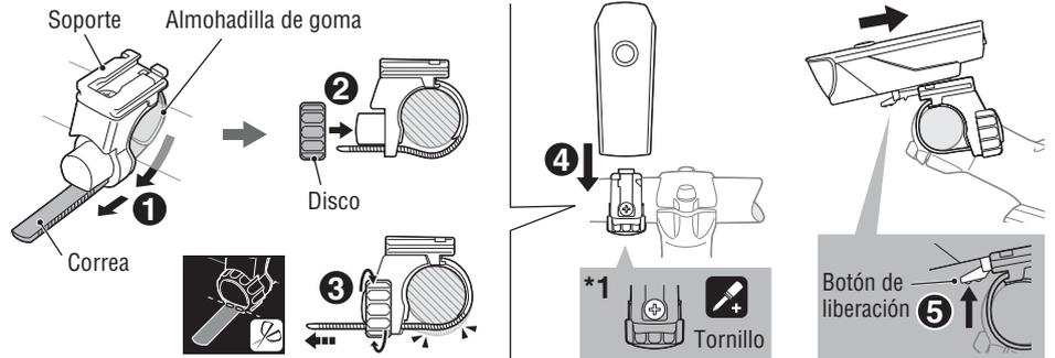
\*1: Compruebe el disco y el tornillo (\*1) del soporte periódicamente. Utilice ambos sin ningún tipo de holgura.
