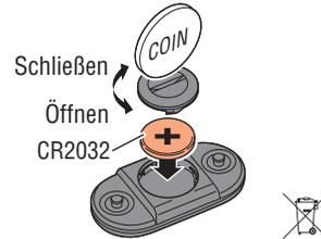
\* Setzen Sie den Sensor beim Austausch der Sensorbatterie mit der **RESET**-Taste zurück.
