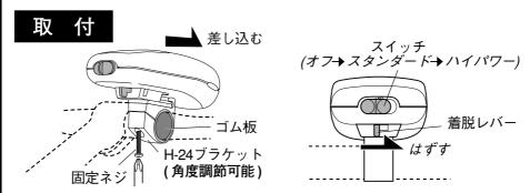
ハンドルにブラケットをセットし仮止めします。ハンドルが細い場合はゴム板で調整します。 本体をブラケットへカチッと音がするまで差し込み、照射角度を調整した後、固定ネジを しっかりとしめ付けます。
