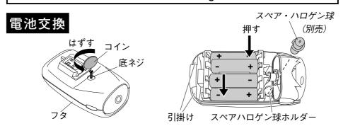
コインで底ネジをゆるめフタをはずし、電池の十、一を正しく入れます。 両端の電池が取り外しにくい場合、矢印の所を押します。 後部の引掛けにフタ後部を引掛けてかぶせ、底ネジをしめます。
