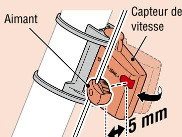
\* L'aimant peut être installé dans n'importe quelle position sur les rayons tant que les conditions d'installation sont respectées.
