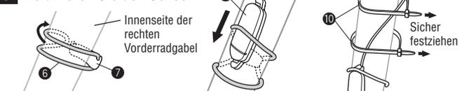
\* Sie können auch Kabelbinder 10 (anstelle des Sensorgummibandes 6) verwenden, um den Sensor zu sichern.
