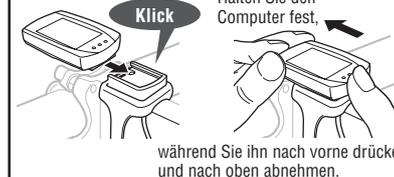
\* Drehen Sie nach der Installation das Vorderrad etwas, um zu überprüfen, ob die Geschwindigkeit auf dem Computer angezeigt wird. Falls die Geschwindigkeit nicht angezeigt wird, überprüfen Sie, ob die Bedingungen **A** und **B** erfüllt sind.
