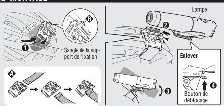
1. Serrer fermement la fixation de casque à la partie avant du casque, en faisant passer la sangle de la support de fi xation à travers les trous de ventilation du casque. (Fig 2 1)
