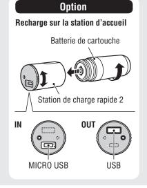
1. Branchez le bloc d'éclairage sur votre PC ou sur un chargeur de batterie USB du commerce en utilisant le câble USB.(Fig 1 1 - 2). Le voyant s'allume, le chargement démarre.
