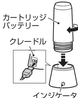
1. ライト本体と PC または市販の USB 充電器を USB ケーブルで接続します。(①～②) スイッチもしくはクレードルのインジケータが点灯し充電が始まります。
