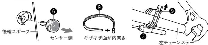
**重要** 後輪が回転したときマグネット⑥の中心がセンサー③の指示線を通過するように位置を調整し、マグネット⑥とのすきまが5mm以内になるように調整してから、ナイロンタイを締めつけます。
